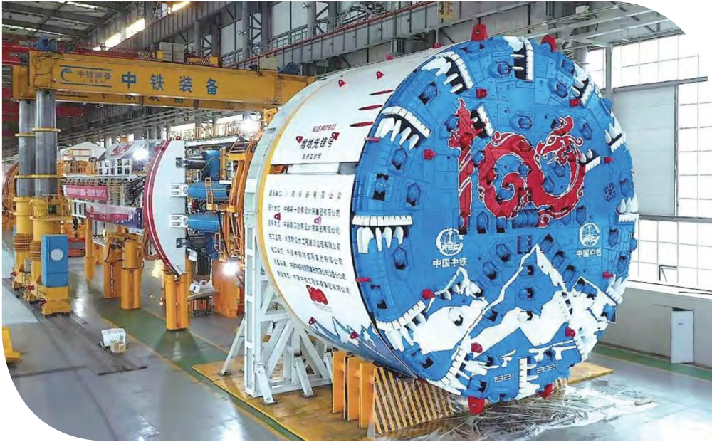
国产首台高原高寒大直径硬岩掘进机“雪域先锋号”是目前国产最大直径的敞开式 TBM，也是世界首台双结构 TBM，应用于高原铁路建设，为极端地质条件下隧道施工提供了强有力的支撑，具有十分重要的意义，是面向国家重大战略需求，创新推动高水平科技自立自强的又一重大成果。
