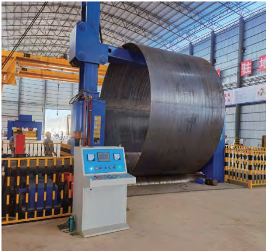
公司参建的第一个引水工程项目——滇中引水项目首节压力钢管卷制成功。
